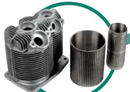
Cuerpo de aluminio moldeado sobre una camisa de fundición de hierro que garantiza una máxima transferencia de calor y durabilidad\*, solo en R-10, R-15, R-30.
